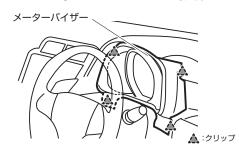
4. エアコン吹出し口取り外し クリップを浮かせ、エアコン吹出し口を取り外します。
