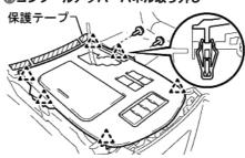
斜線の位置に保護テープを貼る スクリュー 2 本を取り外す シフトレバーを N ポジションにする クリップのかん合を外して各コネクターを切り離す
