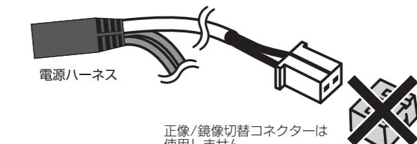
⚠️ カメラに電源が入った状態で、正像/鏡像切替コネクターを取り付けたり取り外したりしないでください。
