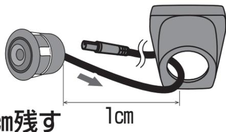
重要 ●カメラカバーの穴にカメラ本体をはめ込みます。ケーブルを1cm程度残してください。はめ込むとカメラの角度調整ができなくなります。
