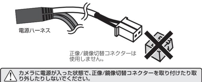
▲カメラに電源が入った状態で、正像/鏡像切替コネクタを取り付けたり取り外したりしないでください。
