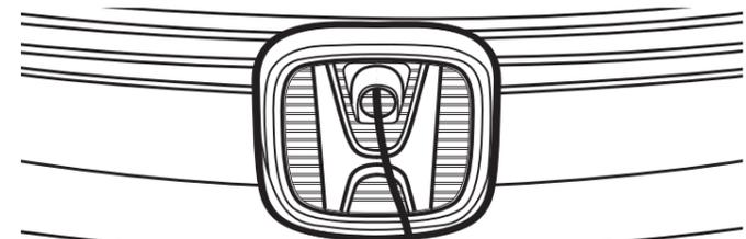
重要 ●カメラカバーは下図のように後端が取り付け部の奥に当たるまで入れます。また取り付け部の中央に貼り付けてください。
