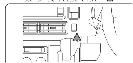
**△ 注意** インストパネル脱着時にオド・トリップメータのスイッチに干渉(破損)しないよう注意してください。
