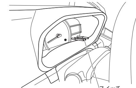
**⚠ 注意** インストパネル脱着時にオド・トリップメータのスイッチに干渉(破損)しないよう注意してください。
