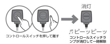
3 再度ブザーが鳴るまでコントロールスイッチを長押しすると感度が変更されます。
