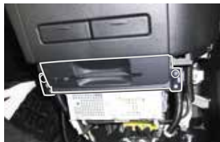
図4 AVユニットカバー取り外し
