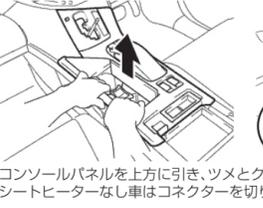
コンソールパネルを上方に引き、ツメとクリップのかん合を外す。シートヒーターなし車はコネクタを切り離す。
