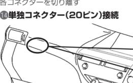
図の丸印部分、エアバッグを止めているボルトの奥付近にコネクタがあります。
