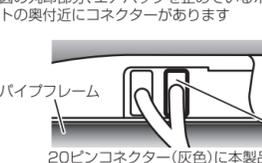
パイプフレーム エアバッグを止めているボルト 20ピンコネクタ(灰色) 20ピンコネクタ(灰色)に本製品を割り込ませる。
