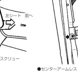
●左側シート中央下部の取り付けスクリューを取り外します。
