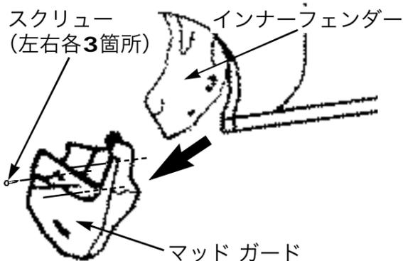
初めにスクリュー(3箇所)を外し、フロントマッドガードを取り外します。
