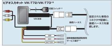
※1:別途ご用意ください。※2 同梱のケーブル長は予告なく変更する場合があります。※3:付属はVIK-T73のみ。※4:「BATTERY」「ACC」「GND」の各配線はサービス端子です。再生する映像機器の電源取得に使用ください。再生する映像機器への接続以外の電源取得には使用しないでください。 ※5.TV-KITを装備されている方は、VIK-T72をお選びください。
