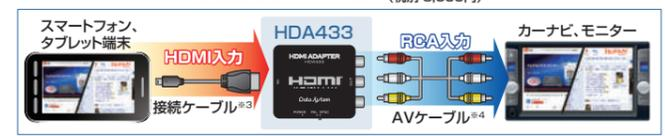
HDMI信号をアナログ信号に変換してRCA出力しますので、RCA入力を搭載した
