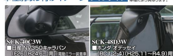
※車種別サイドツインカメラキットは2台のカメラがそれぞれ独立して映像を出力するためナビやモニターに直接接続することができません。本製品を使用するには、2つの映像を合成できる当社製マルチカメラスプレッターMCS296が別途必要になります。
